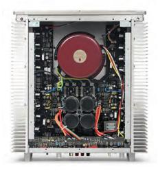
Классический вид для усилителя мощности такого уровня. В сердце фирменный трансформатор, банк из четырех конденсаторов, идеальный монтаж и расположение элементов на платах, и даже набор предохранителей прямо в блоке питания.
