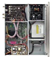
Обратите внимание — корпус плеера внутри разделен на герметич- ные отсеки, защищенные друг от друга солиднейшей толщины алюминиевыми переборками.
