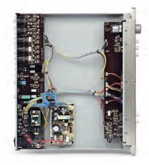
Конструкция преда предельно минималистична, хотя более ортодоксальные разработчики наверняка уместили бы в свободное пространство хороший транс и традиционный блок питания вместо эффективного импульсного. Ну и цену бы тоже подняли.
